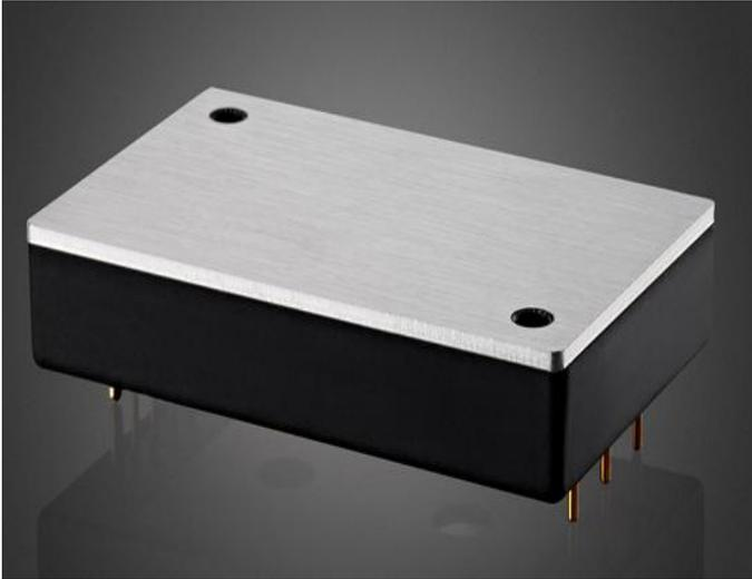
EQ100-500SXX 系列为宽范围、高可靠、高效率的单路输出隔离 DC/DC 变换器。该系列模块电源输入电压范围为 400-650VDC，最大输出电流为 15A，最大功率 100W。EQ100-500SXX 系列模块提供使能控制，有正逻辑或负逻辑控制可选；散热安装方式有通孔或者螺纹孔可选；工作温度有 -40~+100°C 或 -55~+100°C 可选。
