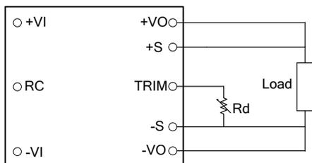
“ $V_{O,SET}$ ”为 TRIM 悬空时输出电压设定值,  $V_{DESIRED}$  为调整后的输出电压, “ $\Delta$ ”为输出电压的变化率\*100, 如: 把 28.0V 输出上调为 30.8V, 即  $\Delta = (30.8 - 28.0) / 28.0 * 100 = 10$ ; 把 28.0V 输出下调为 25.2V, 即  $\Delta$
