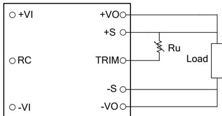
输出下调: 在模块 TRIM 和 -S 之间外接电阻, 可以实现输出电压下调。
