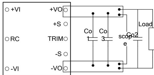
纹波测量一般在额定输入和输出情况下测量，在模块输出 3-5cm 左右的附近接测量。电容采用 10 $\mu$ F 的钽电容并联 0.1 $\mu$ F 的陶瓷电容，示波器带宽设置为 20MHz。
