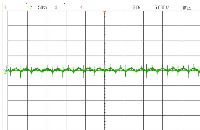
输出电压纹波波形(额定输入,满载)
