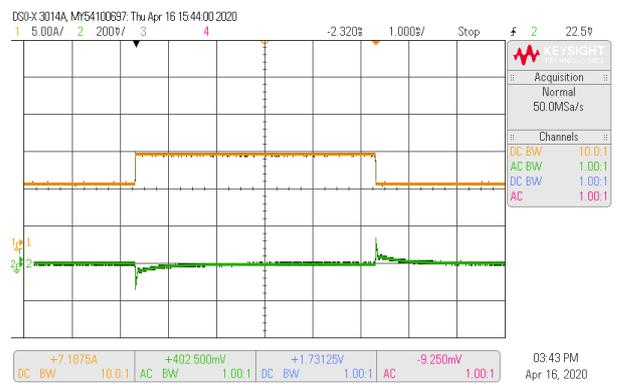
输出电压动态波形 (50%~75%~50% Iout)
