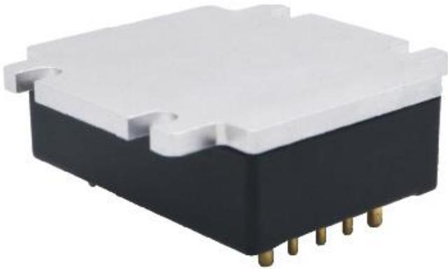
ES80-28SXX 低压系列为宽范围、高可靠、高效率的单路输出隔离 DC/DC 变换器。该系列模块电源输入电压为 (16-40)V，最大输出电流为 24A，最大功率 80W。ES80-28SXX 低压系列模块提供使能控制，有正逻辑或负逻辑控制可选；工作温度有  $-40^{\circ}\text{C} \sim +100^{\circ}\text{C}$  或  $-55^{\circ}\text{C} \sim +100^{\circ}\text{C}$  可选。
