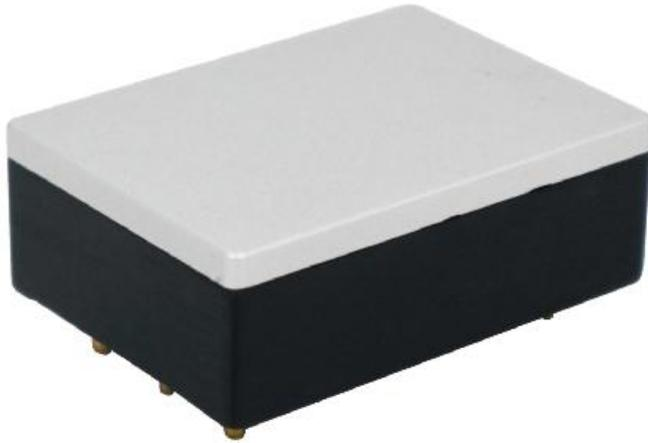
ES50W-24SXX 低压系列十六分之一砖模块电源为宽范围、高可靠、高效率的单路输出隔离 DC/DC 变换器。该系列模块电源输入电压为(9-40)V，最大输出电流为 10A，最大功率 50W。ES50W-24SXX 系列模块提供使能控制，有正逻辑或负逻辑控制可选；工作温度有-40℃~+100℃或-55℃~+100℃可选。
