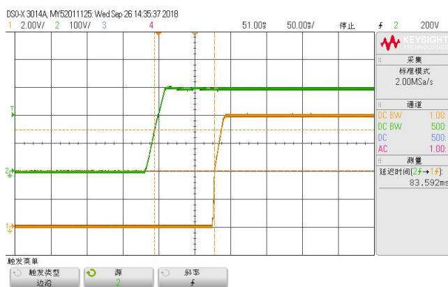
启动波形(额定 300VDC 输入,满载) CH1:输出电压 CH2:输入电压
