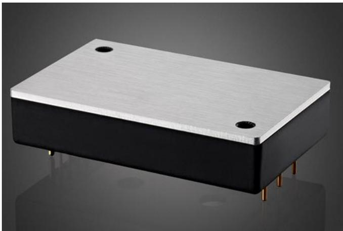
EQ150-110SXXB 系列为宽范围、高可靠、高效率的单路输出隔离 DC/DC 变换器。该系列模块电源输入电压为 66-160VDC，最大输出电流为 30A，最大功率 150W。EQ150-110SXXB 系列模块提供使能控制，有正逻辑或负逻辑控制可选；散热安装方式有通孔或者螺纹孔可选；工作基板温度 $-40^{\circ}\text{C}\sim+100^{\circ}\text{C}$ 。
